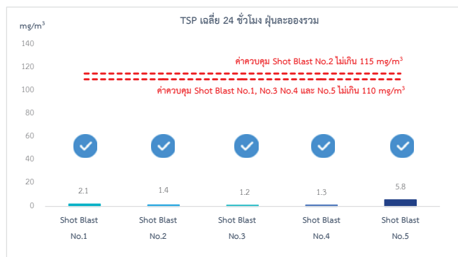
รูปที่ 9 ผลการตรวจวัดมลพิษทางอากาศจากแหล่งกำเนิด ปล่องจากเครื่องขัดผิวชิ้นงาน (Short Blast)
