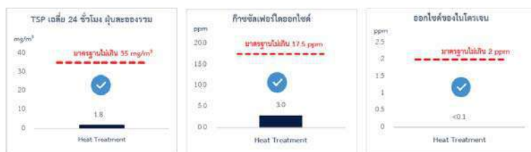
รูปที่ 10 ผลการตรวจวัดมลพิษทางอากาศจากแหล่งกำเนิด ปล่องจากเตาอบ (Heat Treatment)
